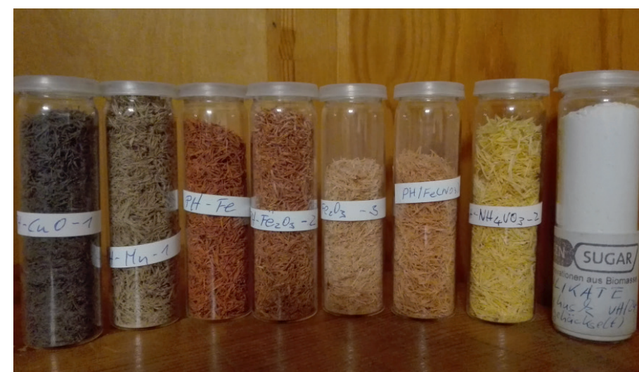
Pflanzenbasierte Silikate, welche aus Reisspelzen gewonnen und mit verschiedenen Metallen beschichtet wurden. Diese können als Farbstoffträger und Härtungsmittel in Lacken aber auch als Katalysator in chemischen Prozessen eingesetzt werden.
